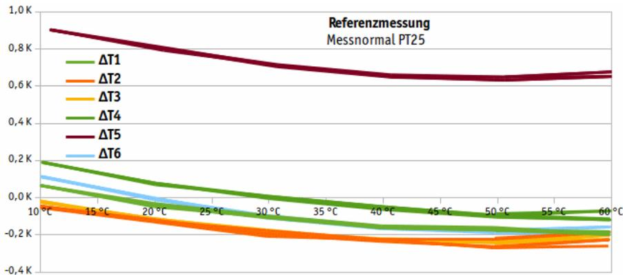
Es lässt sich abschätzen, dass für den Meesbereich -55°C bis 125°C die Linearitätsabweichung in angegebenen Bereich bleiben wird für T1-T4, T6. Korrigiert man die Messwerte mit einer festen quadratischen Korrektur und einem sensorspezifischen Offset, erhält man folgendes Ergebnis:
